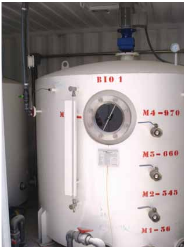
Digestor experimental de 2700L de capacidad, con 4 salidas de tomas de muestras.
